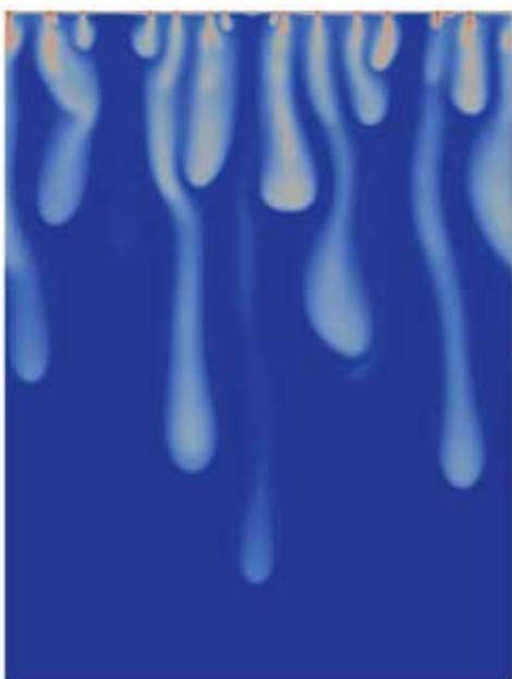
Figure 4 : Exemple de simulation numérique de convection sous forme de doigts se produisant lorsque du \text{CO}_2 (en rouge ici) se dissout dans une phase aqueuse à partir du bord supérieur.
