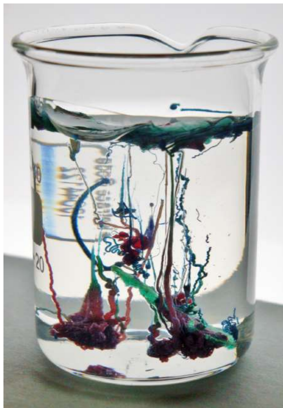
Figure 3.: Exemple de jardin chimique : tiges ayant grandi de façon erratique à partir graines de sel métallique semées dans un bécher rempli de silicate de sodium.
