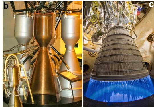
**FIGURE 3.2 – a.** Schéma de l'écoulement dans une tuyère. **b.** Moteur de fusée RD-107 exposé au musée d'astronautique de Saint-Petersbourg. **c.** Test d'un moteur de fusée cryogénique (Common Extensible Cryogenic Engine).
